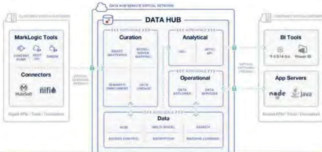
L'architecture type d'un data hub. Ici, celui proposé par l'éditeur MarkLogic.
